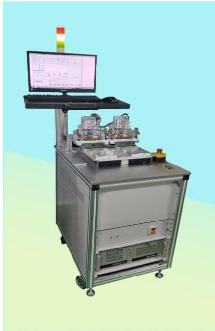
KH5665 多通道晶体高激励机设计為支援载盘式微调机，如 KH2200 系统，提供贴片晶体的高激励操作需求。
