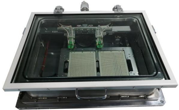
KF720S 是在旧式圈形微调机升级为载盘式的产品。载盘式直线微调机是采用全新的载盘微调方式，简化了传统圈形微调机的上、下圈工序，把点胶、微调、碰焊工序用载盘作为传输载体，直接连系在一起，因而提升整体生产效益。升级适用于科研微调机、日本 SC-6SA、国产微调机(详情请与科研联络)
